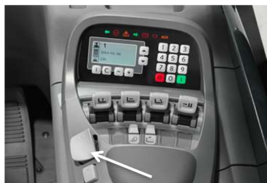
Rijrichtingkeuze op console reachtruck (Toyota/BT)
