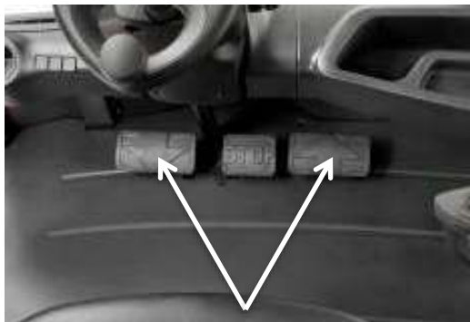
Twee pedalen voor vooruit en achteruit (Linde)
